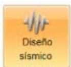
PROFIS Rebar selecciona el diseño sísmico por defecto cuando se abre un proyecto de armadura para momento especial. Los cálculos serán realizados según ACI 318-11 Capítulo 21.
