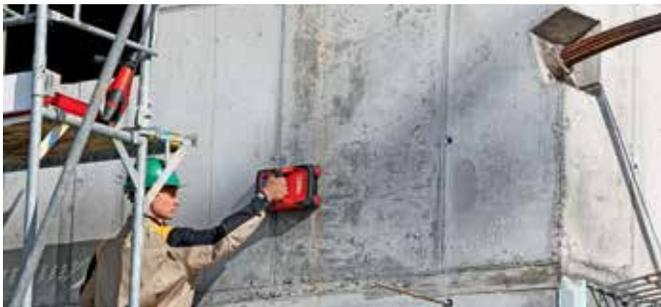
**Figura 5: Detección de barras de refuerzo y otros elementos empotrados con un escáner basado en GPR Hilti**
